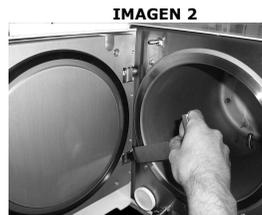
**Ajustar solo una vuelta uniformemente (sea sobre que bajo) y probar el ciclo**
