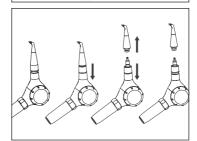
Eche aire comprimido en el recipiente de polvo, en el tapón y en la cavidad del conector de la pieza de mano, a fin de eliminar todos los residuos de polvo;
