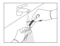
Cepille delicadamente la superficie de la aguja para la limpieza bajo agua corriente con un cepillo de cerdas suaves de nylon; Poner la aguja para la limpieza en una cuba de ultrasonidos sumergido en la solución de detergente enzimático a 40°C ±2°C, durante al menos 10 minutos;
