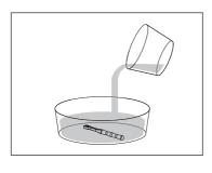
Introducir la llave K9 en un recipiente limpio, en posición horizontal y añadir una cantidad de la solución de detergente enzimático suficiente para cubrir completamente la llave K9;
