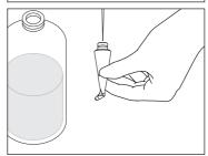
Poner el terminal limpiador en una cuba de ultrasonidos sumergido en la solución de detergente enzimático a 40°C ±2°C, durante al menos 10 minutos;
