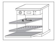
Procedimiento validado con lavainstrumentos/ desinfectadora Miele PG8535. Programa Miele DES-VAR-TD. Detergente alcalino: neodisher® FA (0.2 % v/v). Líquido neutralizante: neodisher® Z (0.1 %v/v).
