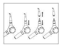
3 Sujete el Starjet, deslice la abrazadera manteniéndola en esa posición, quite el terminal limpiador, por último suelte la abrazadera del Starjet;
