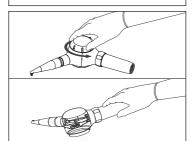
Sujete el Starjet, deslice la abrazadera manteniéndola en esa posición, quite el terminal limpiador, por último suelte la abrazadera del Starjet;
