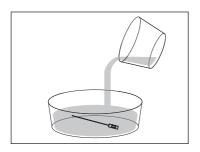
Introducir la aguja para la limpieza en un recipiente limpio, en posición horizontal y añadir una cantidad de la solución de detergente enzimático suficiente para cubrir completamente la aguja para la limpieza;
