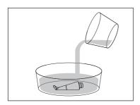
Introducir el terminal limpiador en un recipiente limpio, en posición horizontal y añadir una cantidad de la solución de detergente enzimático suficiente para cubrir completamente el terminal limpiador;
