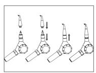
Sujete el Starjet , deslice la abrazadera manteniéndola en esa posición, introducir el terminal limpiador hasta el tope, luego suelte la abrazadera del Starjet;
