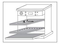
Procedimiento validado con lavainstrumentos/ desinfectadora Miele PG8535. Programa Miele DES-VAR-TD. Detergente alcalino: neodisher® FA (0.2 % v/v). Líquido neutralizante: neodisher® Z (0.1 % v/v). 2 Secuencia y parámetros aplicables al ciclo:
