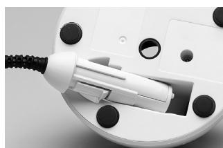
Conecte el cable eléctrico al suministro energético y a la unidad de alimentación. Asegúrese que el cable eléctrico esté accesible en todo momento y que pueda ser fácilmente desconectado de la fuente de alimentación. La base de carga mostrará brevemente "Bluephase G4" como texto de teletipo en la pantalla.
