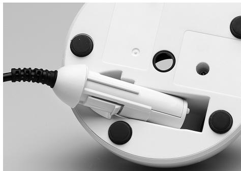
Inserte la clavija de conexión en la pieza de mano hasta que oiga y sienta que ha encajado en su posición.
