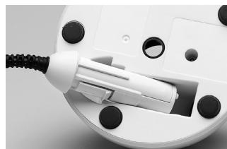
Collegare il cavo di alimentazione alla rete ed al trasformatore. Prestare attenzione che il cavo di alimentazione sia accessibile in qualsiasi momento e possa essere scollegato facilmente dalla rete. La base di ricarica mostra sul display la scritta "Bluephase G4".
