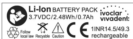
Por favor, tenga en cuenta que la batería de polímero de litio puede reaccionar con explosión, fuego y producir humo en caso de una manipulación inapropiada y daños mecánicos. Las baterías de polímero de litio dañadas, no deben volver a utilizarse.
