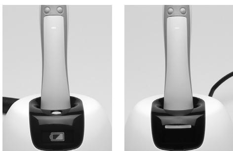
La batteria è un materiale di consumo, che generalmente deve essere sostituito dopo ca. 2½ anni. L'età della batteria può essere rilevata dall'etichetta sulla batteria stessa.
