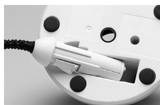
Netzkabel an das Versorgungsnetz anschliessen und mit dem Netzgerät verbinden. Hierbei ist darauf zu achten, dass das Netzkabel jederzeit einfach zugänglich ist und leicht vom Versorgungsnetz getrennt werden kann. Die Ladestation zeigt auf dem Display kurz in Laufschrift "Bluephase G4" an.
