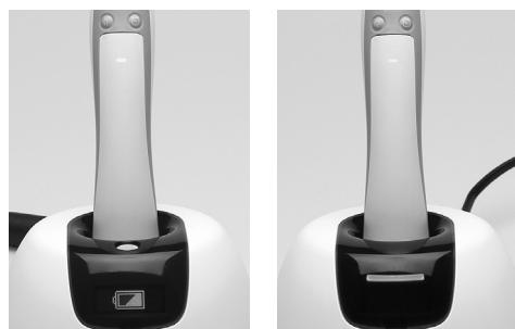
Der Akku ist ein Verschleissteil, das typischerweise nach ca. 2½ Jahren erneuert werden muss. Das Alter des Akkus kann dem Akkuaufkleber entnommen werden.
