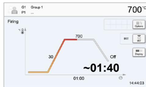
Premendo il tasto IRT (vedi capitolo 5.1.2) durante il processo di chiusura ed asciugatura si può passare alla visualizzazione della camera ad infrarossi. Premendo nuovamente si torna alla visualizzazione della curva di cottura.
