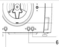
Vacie el depósito de carga del autoclave, por la parte frontal inferior ( véase el manual de uso del autoclave) figura 6 del manual.
