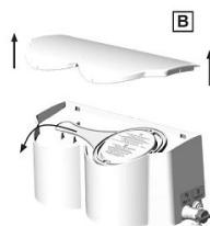
Levante la tapa de la unidad de desmineralización y extraiga la llave para el ajuste / desmontaje de los recipientes que está ubicada en su interior.
