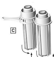
Coloque los dos recipientes con los cartuchos debajo de sus cabezales de rosca que están fijados a la unidad desmineralizadora; luego, utilizando la llave suministrada con el aparato atornille los recipientes en el sentido contrario a las agujas del reloj (con fuerza moderada)
