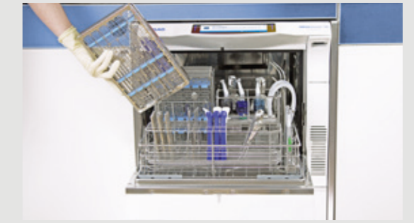
Limpieza y desinfección de bandejas MELAstore® con termodesinfectadoras MELAG
