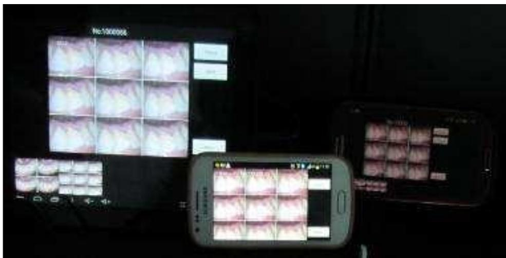
A través del WIFI conectado a la tableta o al móvil, se puede llevar a cabo un display sincrónico de cámara partida 1,4,9 (soporte Windows, Android)
