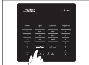
Mientras el mensaje PUMP/FLUSH parpadea, pisar el pedal una vez y soltarlo, PUMP/FLUSH deja de parpadear y el circuito de irrigación comienza a llenarse;
