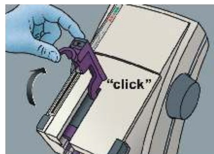
Fig.9 La palanca de seguro es asegurada en la posición más vertical.
