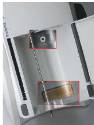
Fig.5a El sensor y la Etiqueta de Autenticación detectan cartuchos/materiales ilegibles.
