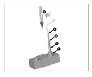
Limpieza y desinfección mecánicas de los tubos de refrigerante para la refrigeración interna de la fresa, la bifurcación Y y el clip del tubo de spray.
