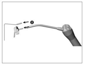
2 Seque el tubo de refrigerante y los orificios de salida con aire comprimido.
